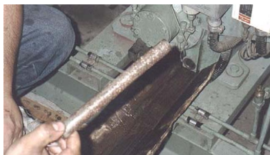
Foto 2 Filtro de arraste do óleo entupido de “limalhas de cobre” provenientes da instalação. Recomenda-se sua limpeza sempre que houver baixo diferencial de pressão da bomba de óleo ou nas trocas periódicas do óleo do cárter
