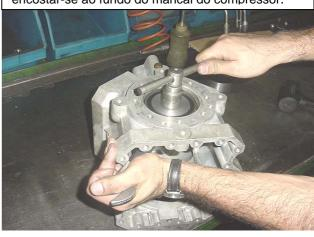
**19º Passo:** Após a colocação do rolamento no compressor. retire o dispositivo.
