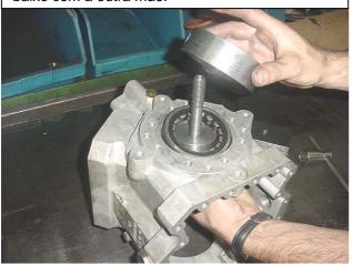
**12º Passo:** Retire o disco + parafuso juntamente com o rolamento. Fim da operação para retirada do rolam.
