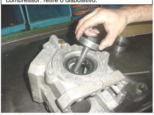
**20º Passo:** Apresentação do rolamento fixado no mancal e do dispositivo montado para transporte.
