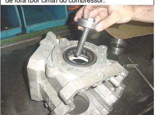
**16º Passo:** Colocar a base e a porca por dentro do compressor. Nesta operação não se utiliza o aro.
