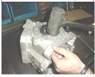
**15º Passo:** Colocar o disco + parafuso pelo lado de fora (por cima) do compressor.
