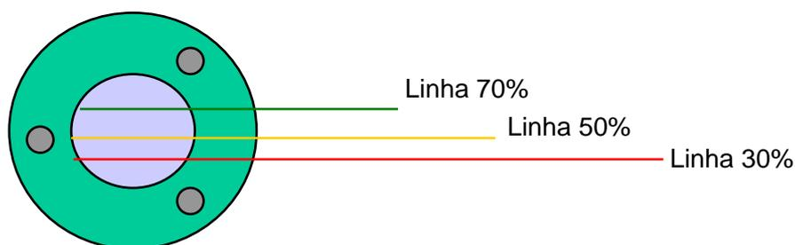
Figura 3: Zonas de operação do regulador nível de óleo eletrônico Traxoil TR3
